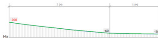
Рис. 4. Эпюра изгибающих моментов / Curve of the bending moments
