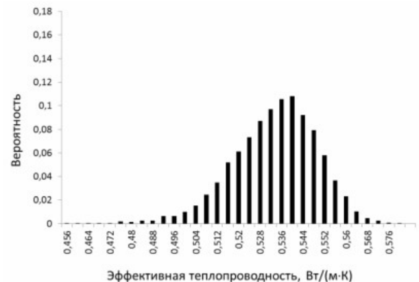
Рис. 1. Распределение \lambda_{eff} , полученное в материале с a = 4h , d_{min} = 0 и \eta = 0,28 / \lambda_{eff} distribution in the material with a = 4h , d_{min} = 0 and \eta = 0,28 .
