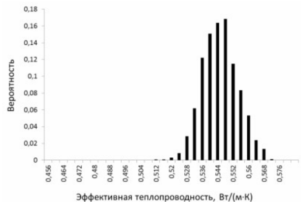
Рис. 2. Распределение \lambda_{eff} , полученное в материале с a = 4h , d_{min} = 3h и \eta = 0,28 / \lambda_{eff} distribution in the material with a = 4h , d_{min} = 3h and \eta = 0,28 .
