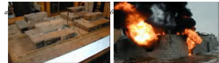
Рис. 4. Общий вид огневых испытаний а- плит и плоских фрагментов, б – объемных фрагментов каркаса
