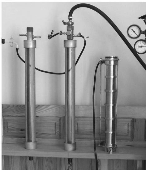
Рис. 1. Прибор для лабораторных исследований закрепляемости грунтов ПЛЗ-2
