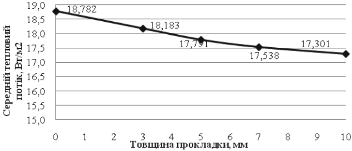
Рис. 4. Графік середніх значень теплового потоку через 1м 2 стіни з ЛСТК в залежності від товщини прокладки
