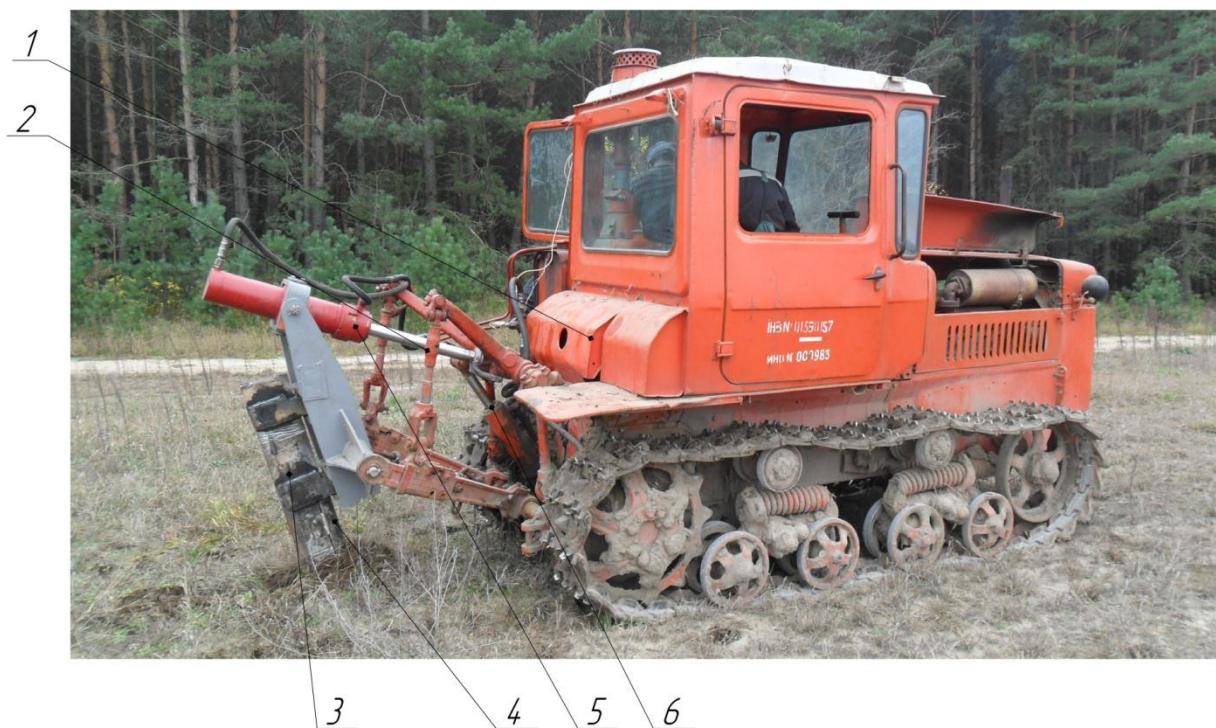
Рис. 1. Тягач з дослідними ножами: 1 – базова машина (трактор ДТ-75); 2 – гідравлічна навіска; 3 – стояк; 4 – лезо; 5 – гідроциліндр повороту робочого обладнання; 6 – гідроциліндр підйому робочого обладнання.
