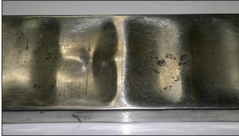
Рисунок 3 – Деформация рабочей камеры ЭМД
