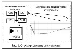
Основными элементами схемы являются: моноимпульсная (простой сигнал, длительность импульса  $\tau_{\rm u}=0.4$  мкс) радиолокационная станция (РЛС), работающая в сантиметровом (1,8 см) диапазоне длин волн; осциллограф (Осц.); частотомер (ЧМ); аналогово-цифровой преобразователь (АЦП) и персональный компьютер (ПЭВМ).
