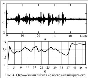
Рис. 4. Отраженный сигнал со всего анализируемого интервала дальности при положении A (a) и зависимость фрактальной размерности от положения "окна" (б)
