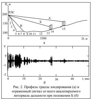
При проведении эксперимента положение диаграммы направленности в азимутальной плоскости фиксировалось (задавалась трасса зондирования), а в угломестной плоскости принимало три значения
