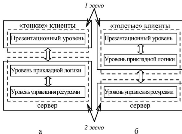
Рис. 3. Двухзвенная клиент-серверная архитектура
