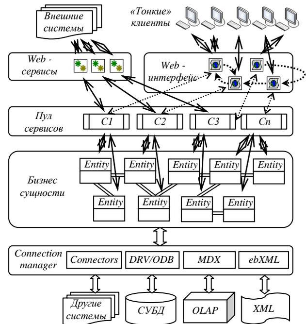
Рис. 5. Программная архитектура SOA
