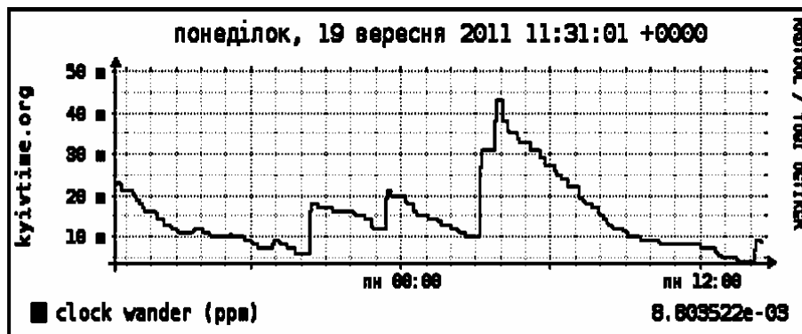
Рис. 11. Контроль сигналу часу від шкали часу водневого стандарту частоти Ч1-80 через мережу Інтернет на сервері kyivtime.org
