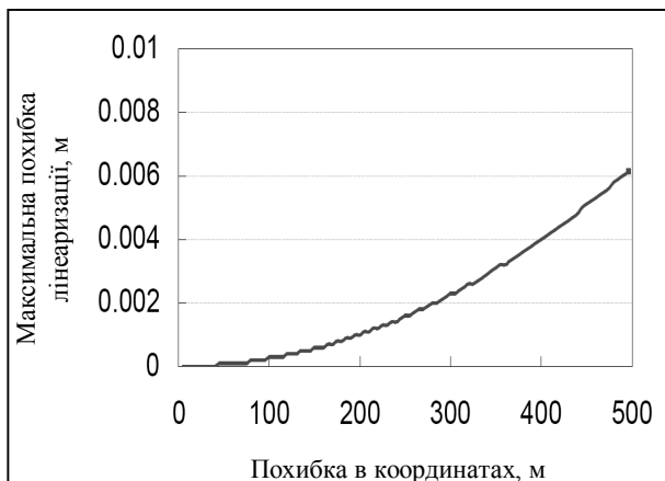
Рис. 1. Максимальна похибка лінеаризації як функція похибки координат для випадку супутникового сигналу (відстань 20000 км)
