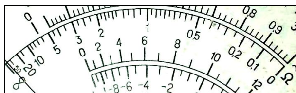
Рис. 1. Шкала сопротивлений вольтметра В7-15
