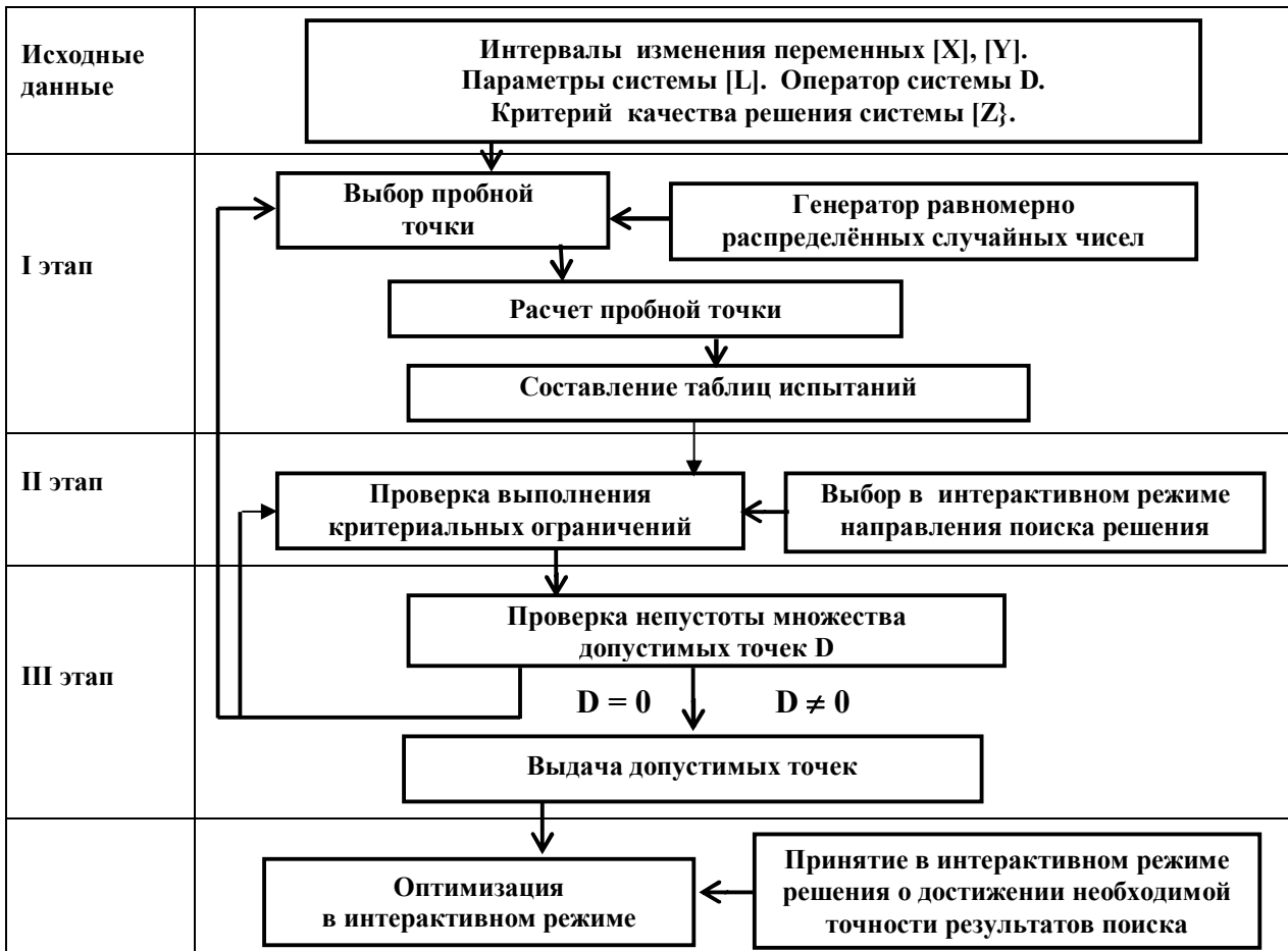
Рис. 4. Укрупнённая блок-схема применения метода исследования пространства параметров
