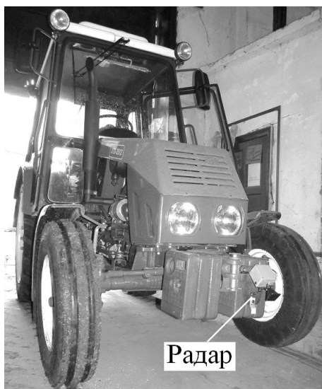
Рис. 7. Расположение (а) и внешний вид (б) бесконтактного датчика на агрегате
