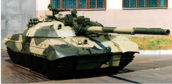
Рис. 21. Модифікований танк Т-62М Бойова вага 42,5 т; екіпаж – 4 чол.; швидкості руху: макс. по шосе – 50 км/год., середня по ґрунт. дорозі – 22...27 км/год.; двигун – диз. В-55М, 620 к.с.; запас ходу по ґрунт. дорогам – 450 км; озброєння: 115-мм ГТГ (42 постріли), ПТРК з лаз. керуванням «Шексна»; кулемети: спарений з гарматою – 7,62 мм; зенітний – 12,7 мм; 2-площинний стабілізатор гармати; лазерний вимірювач відстані; ІЧ-приціл і прилади спостереження командира і м/в; авт. система ПАЗ; ОПВТ – 5 м; сист. постановки маск. завіс «Туча»
