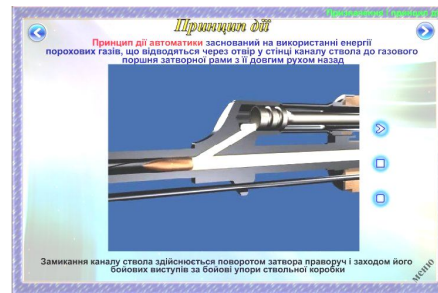
Рис. 3. Принцип дії автоматики
