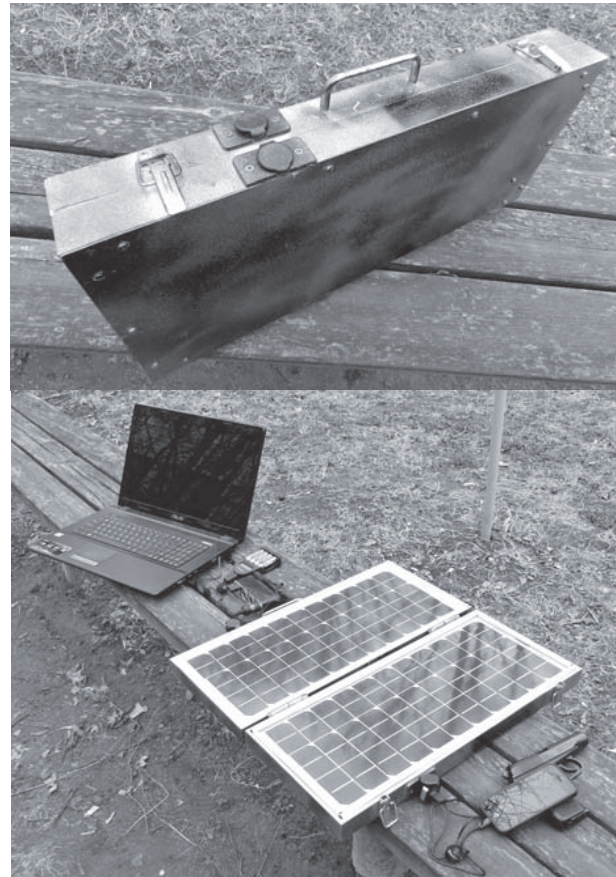
Рис. 4. Конструкція мобільної сонячної електростанції
