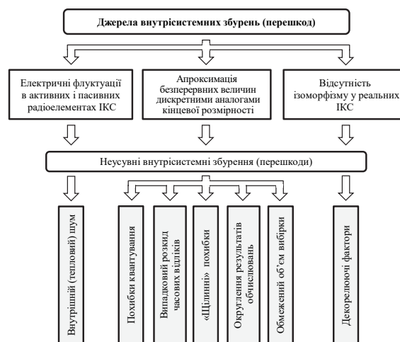
Рис. 3. Джерела внутрісистемних збурень, що впливають на функціонування інформаційно-керуючої системи РТК
