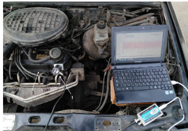
Рис. 1. П'єзодатчик (акселерометр) фірми SCNENCK встановлений на кришці ГРМ в безпосередній близькості від випускного клапана 4 циліндра: 1 – п'єзодатчик; 2 – кришка ГРМ
