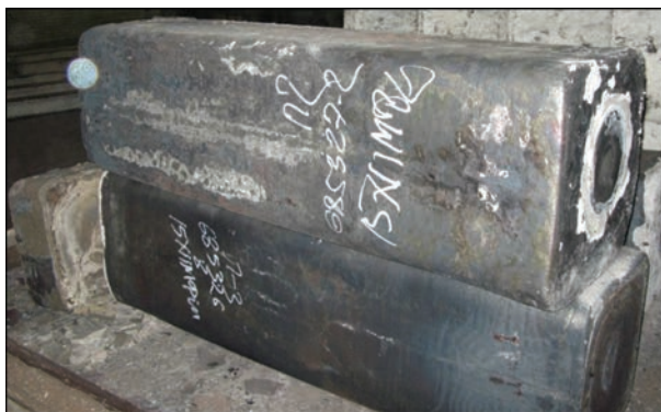
Рис. 2. Зовнішній вигляд поверхонь дослідного (знизу) і порівняльного (зверху) злиwkів ЕШП зі сталі 15X11МФ
