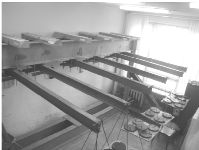
Рисунок 1. Общий вид стенда для проведения длительных испытаний деревянных образцов со стержнями, работающими на выдергивание
