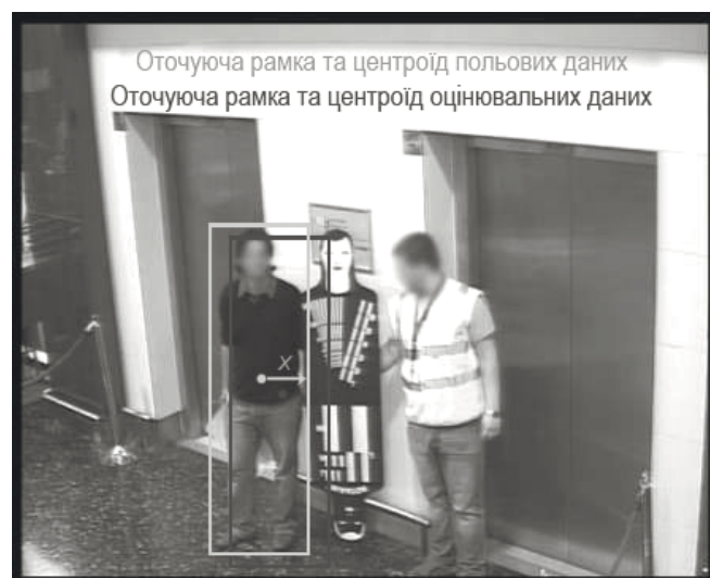
Рис. 1. Приклад дійсного позитивного результату, де оцінювальний центроїд рамки знаходиться в межах відстані x до центроїду рамки польових даних
