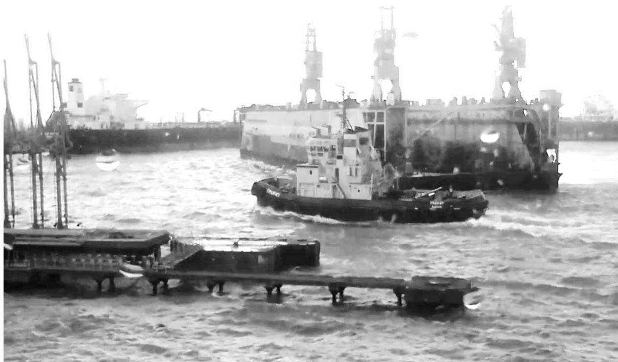
Рис. 2. Движение дрейфующего плавдока с установившейся скоростью при дрейфе в 3,5 узла.
