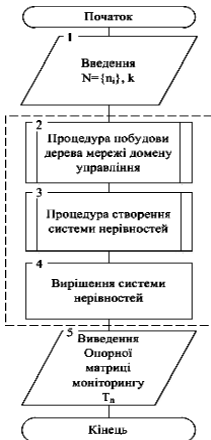
Рис. 1. Алгоритм методики визначення опорної матриці моніторингу домену управління інформаційної мережі спеціального призначення
