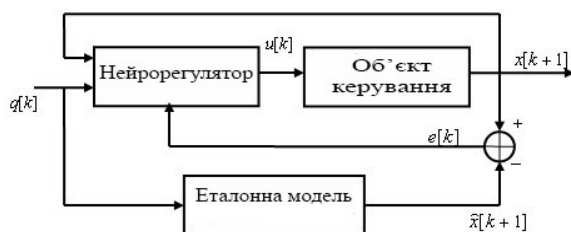
Рис. 2. Нейромережна система керування з еталонною моделлю
