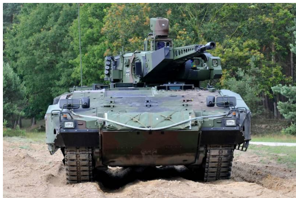
Рис. 1. Зовнішній вигляд башти LANCE з 30-мм гарматою на німецькій БМП PUMA
