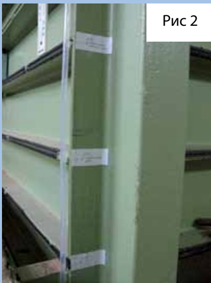
Рис. 2. Индикатор уровня воды в лотке.
