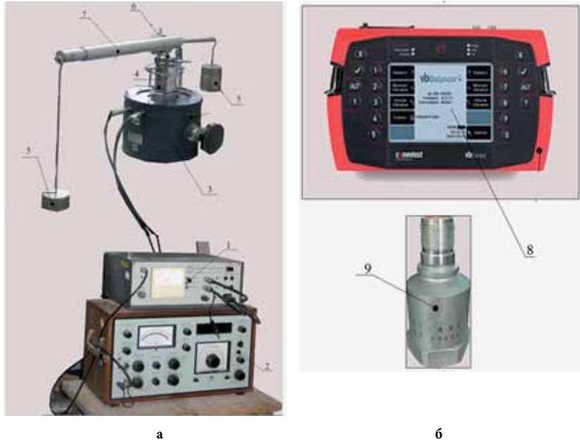
Рис.1. Общий вид лабораторной установки: а - лабораторная установка в рабочем состоянии; б - портативный виброизмерительный прибор VB8 с акселерометром (9) для полевых испытаний грунта вибростампом; 1-усилитель сигнала; 2-генератор колебаний; 3-вибростол; 4-компрессионный или сдвиговой прибор; 5-грузы для рычажного прибора; 6-индикатор часового типа; 7-рычажное устройство для статического нагружения образца; 8-виброметр VB8; 9-акселерометр (датчик для измерения виброускорения штампа в т.ч. гильзы и стакана).
