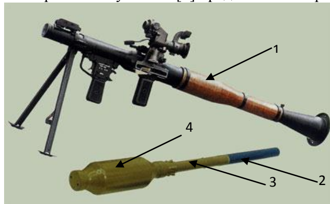
Рис.4. Загальний вигляд та схема конструкції ТБГ-7В с термобаричною бойовою частиною до ручного протитанкового гранатомету РПГ-7:
