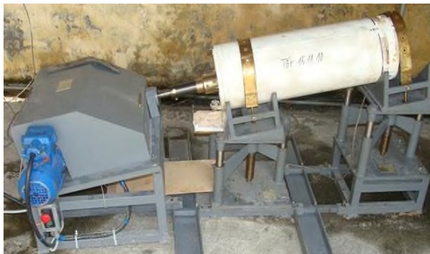
Рис.1. Відбір проб матеріалів спецхімії з бойової частини авіаційної керованої ракети
