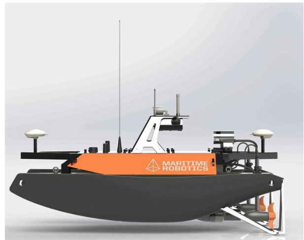
Рис. 14. “Otter” компактний МБЕНА від компанії Maritime Robotics [20] Джерело: [20].
