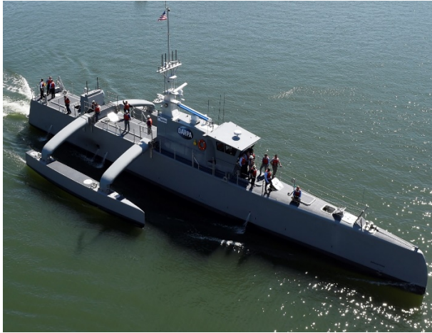
Рис. 11. “Sea Hunter” (“Морський мисливець”) — автономний безкіпажний надводний корабель (USV), побудований в рамках продовження програми DARPA “Безпілотний корабель протичовнової війни” Джерело: [19].
