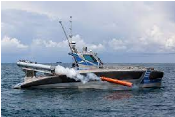
Рис. 2. Безкіпажний катер “Seagull” застосовує торпеду. Джерело: [11].
