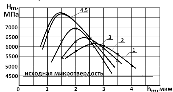
Рис. 8. Зависимость микротвердости от глубины наклепанного слоя для поверхности серого модифицированного чугуна в различных маслах: 1 – минеральное Такт-2Т; 2 – полусинтетическое Пуск-2Т; 3 – синтетическое ELF MOTO 2XT Tech; 4 – рапсовое + П; 5 – подсолнечное +П
