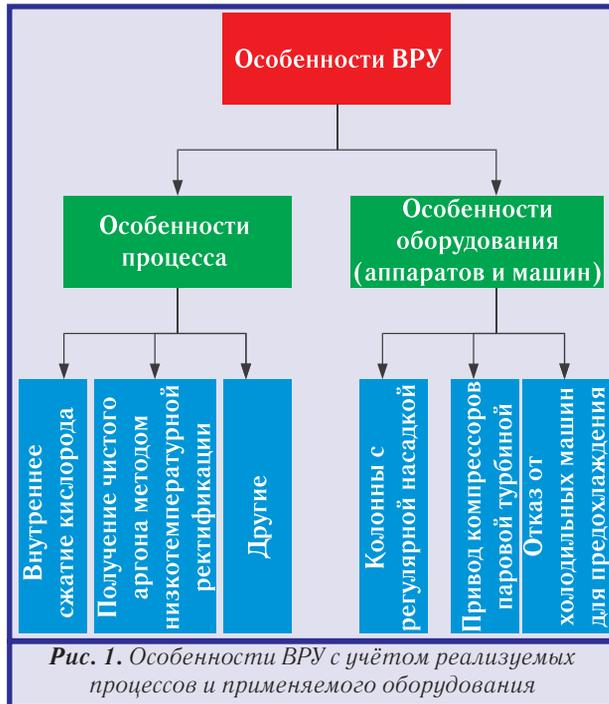
Рис. 1. Особенности ВРУ с учётом реализуемых процессов и применяемого оборудования
