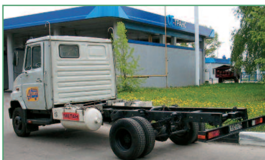
Фото 5. Шасси малотоннажного грузового автомобиля ЗИЛ-5301 «Бычок», переоборудованного для работы на СПГ
