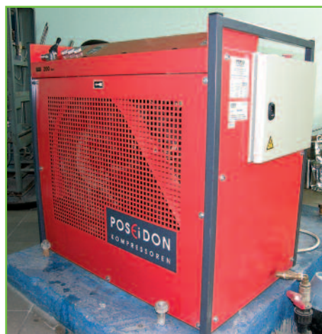
Фото 7. Компрессор для заправки баллонов компримированным гелием
