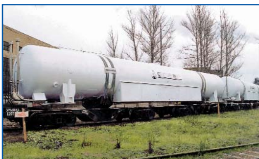
Фото 5. Железнодорожные цистерны объёмом 100 м 3 перед отправкой в Китай
