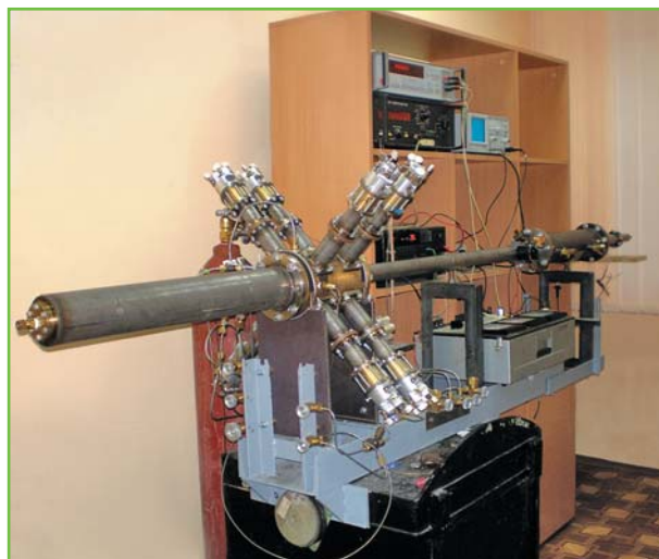
Фото 2. Общий вид макетного образца термоакустического охладителя
