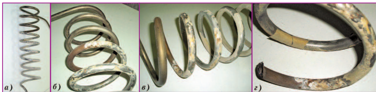
Рис. 2. Внешний вид трубки водяного холодильника и его фрагментов: а — общий вид; б — фрагмент верхней части на границе раздела «воздух — оборотная вода»; в — зона повышенного накипеобразования; г — отслоение образовавшейся накипи
