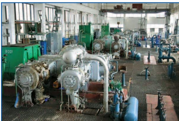
**Фото 1.** Компрессорные установки 4ГМ16-100/200М1 в линии производства карбамида на ОАО «Гродноазот» (Республика Беларусь)
