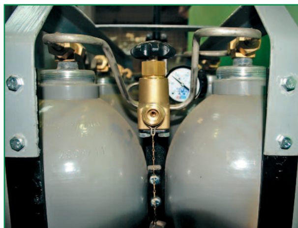
Фото 5. Моноблок с установленным на нём манометром
