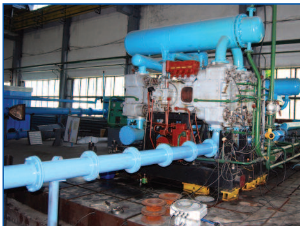
Рис. 6. Проведение испытаний компрессора 4ВМ2,5-18/9 в режиме резонансного наддува
