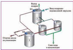
**Puc. 1.** Схема системы разделения водомасляной смеси: 1 — сборник продувок; 2 — накопительный бак; 3, 4 — очистители конденсата; H1, H2 — насосы для выкачивания масла
