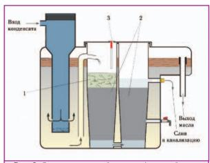
**Рис. 3.** Очиститель конденсата: 1 — предварительный масляный фильтр; 2 — адсорбционные фильтры; 3 — сигнализатор уровня
