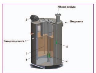
**Рис. 2.** Сборник продувок: 1 — «ложная» обечайка; 2 — насос; 3 — всасывающая труба с фильтром; 4 — поплавок; 5 — противовес
