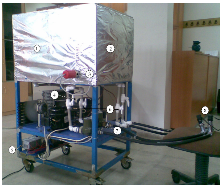
Рис. 3. Система рециркуляции горячей и холодной воды.
