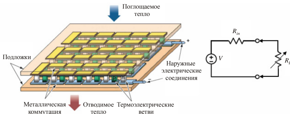
Рис. 1. ТЭМ в режиме генератора и эквивалентная схема ТЭМ.
