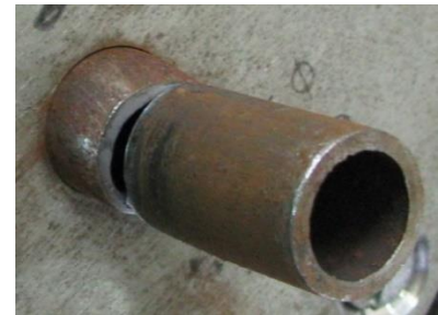
Рис. 10. Траєкторія руху ножів (а), фотографія неповністю відрізаної заготовки зі сталі 20 (б)
