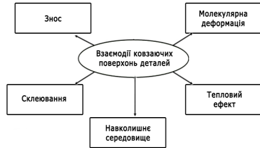
Рис. 2. Схема взаємодій поверхонь ковзання
