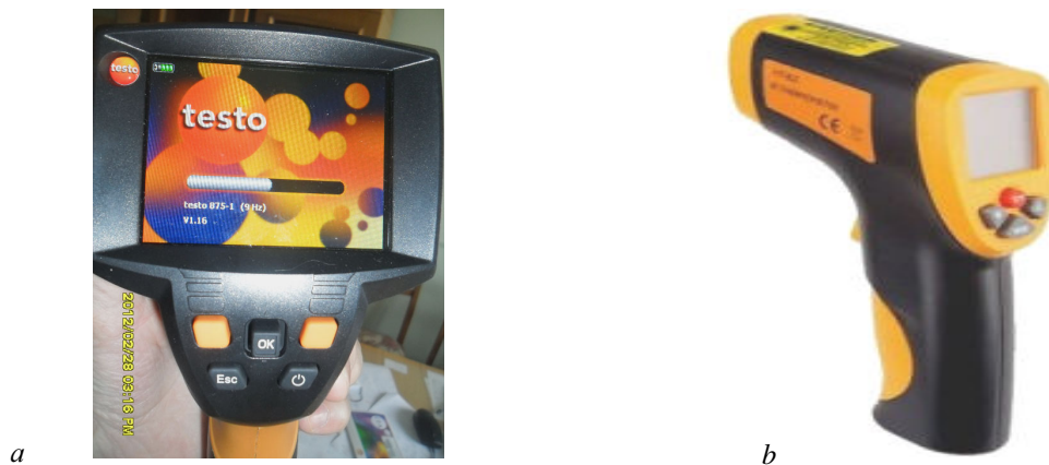
Рисунок 2. Прилади для експериментального вимірювання розподілу температури у мостових конструкціях: а) тепловізор Testo 875-1; б) пірометр NT-822
