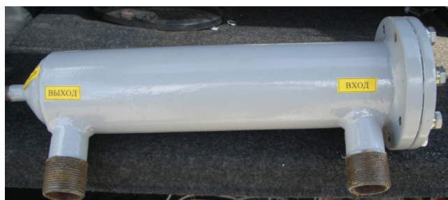
Рис. 3. Гидродинамический фильтр конструкции ДонГТУ.
