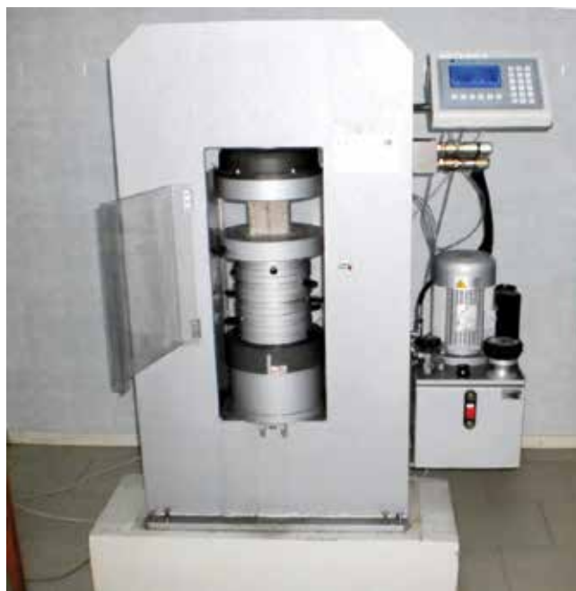
Рис. 1. Лабораторный пресс Tecnotest (компания Modena, Италия), на котором испытывали бетонные образцы с помощью электронного пульта управления, расположенного в правой верхней части прессы.
