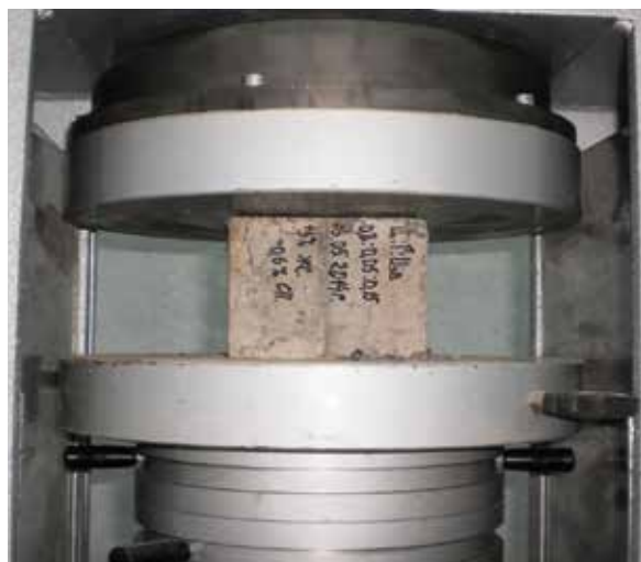
Рис. 4. Прибор для испытания на одноосное сжатие бетонного образца варианта № 5 (состав № 2) с добавкой гипса (0,05 части) и извести (0,15 части) взамен цемента (0,2 части).
