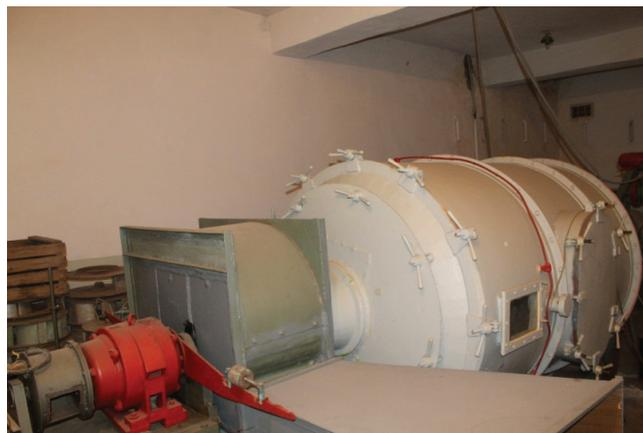
Рис. 1. Аэродинамический стенд для моделирования параметров вентиляторов главного проветривания.
