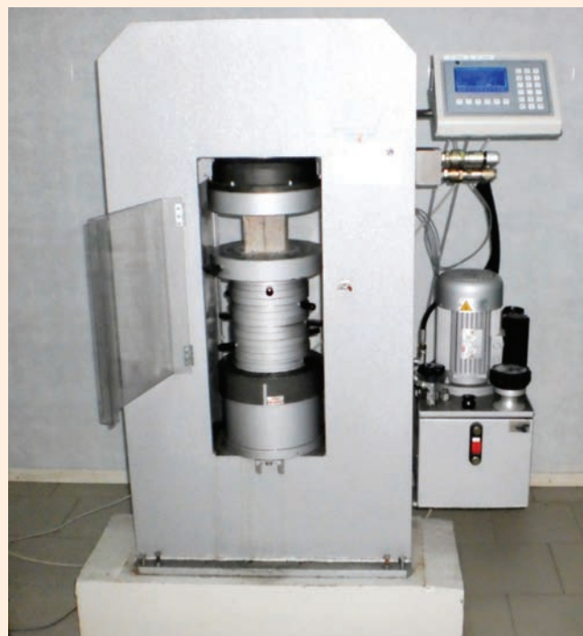
Рис. 3. Лабораторный пресс фирмы Tecnotest (компания Modena, Италия), на котором испытывали бетонные образцы.
